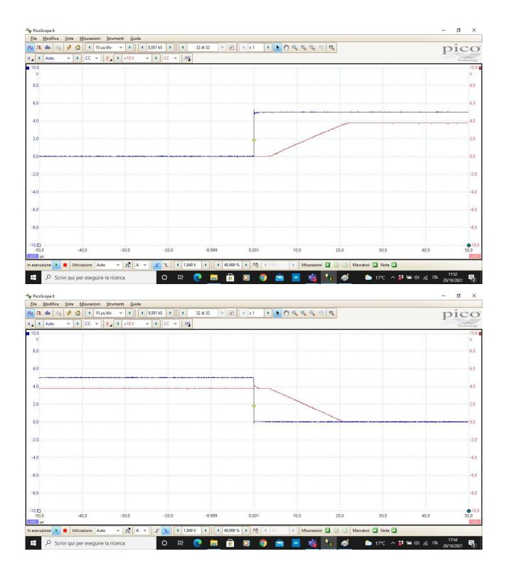
Dal datasheet si osserva che, se alimentato a 15V, ha uno slew rate minimo di 0,3V/us, compatibile con il valore misurato, dato che il dispositivo sta funzionando alimentato a 5V.
